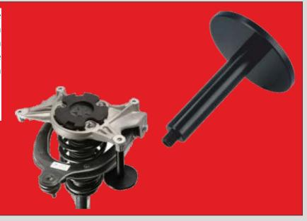
Utilizzato per impostare la posizione iniziale dell'altezza da terra del braccio della sospensione inferiore posteriore, sui veicoli Tesla Model 3 e Model Y. Necessario per la configurazione iniziale quando si sostituiscono i bracci inferiori delle sospensioni, i mozzi, le molle, ecc.
